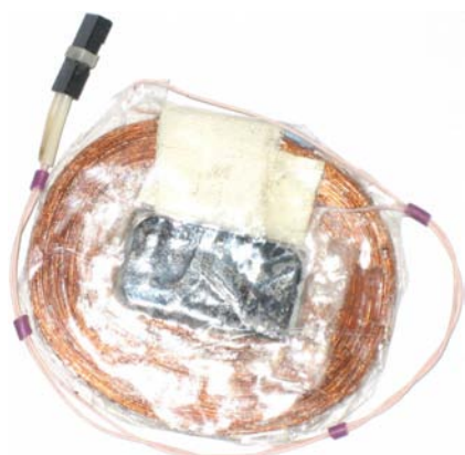
Рис. 34. Внешний вид катушки излучателя
