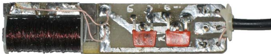
Рис. 77. Внешний вид платы электромагнитного стимулятора
